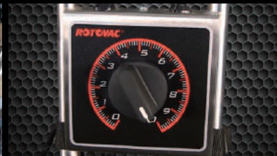
可変式モーターは0~250rpmまで調節可能
