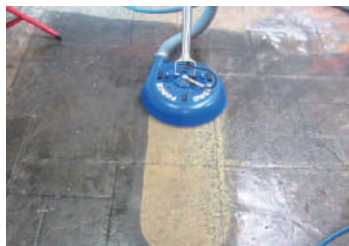
ヘッド部分はFRPとゴムなので壁面を傷を付けにくく安心
