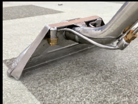
最大500psiの強力な吐出圧力で、パイルの根元までしっかりとした洗浄を実感。
