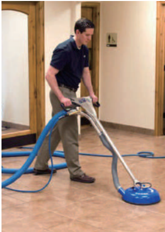
ヘッド部分はFRPとゴムなので壁面を傷を付けにくく安心
